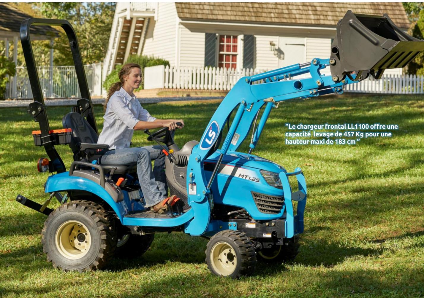
“Le chargeur frontal LL1100 offre une capacité levage de 457 Kg pour une hauteur maxi de 183 cm”
