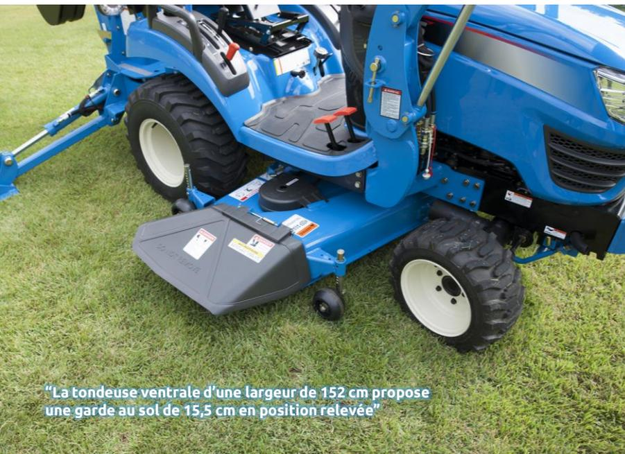
“La tondeuse ventrale d’une largeur de 152 cm propose une garde au sol de 15,5 cm en position relevée”
