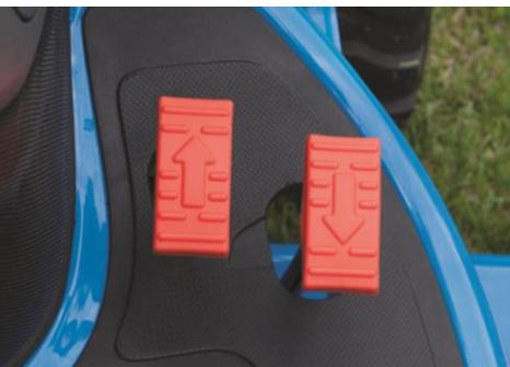
**Transmission hydrostatique à deux pédales**
